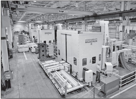
Uno de los cuatro grandes centros de maquinado (vea la ilustración B-2) que forman parte del sistema de producción flexible de la planta de Cincinnati Milacron, en Mt. Orab, Ohio.
