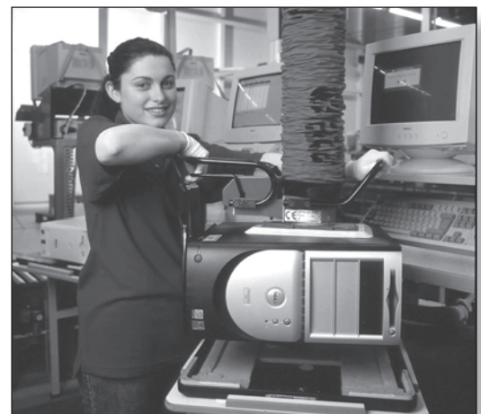
El proceso de manufactura de Dell comprende el ensamble, instalación de software, prueba funcional (inclusive el “quemado”) y control de calidad. El método de JIT de Dell aplica el sistema Pull, pues elabora las computadoras sólo después que el cliente las pide, y solicita materiales a proveedores conforme se necesitan.
